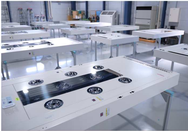
エアシャワー組立作業
